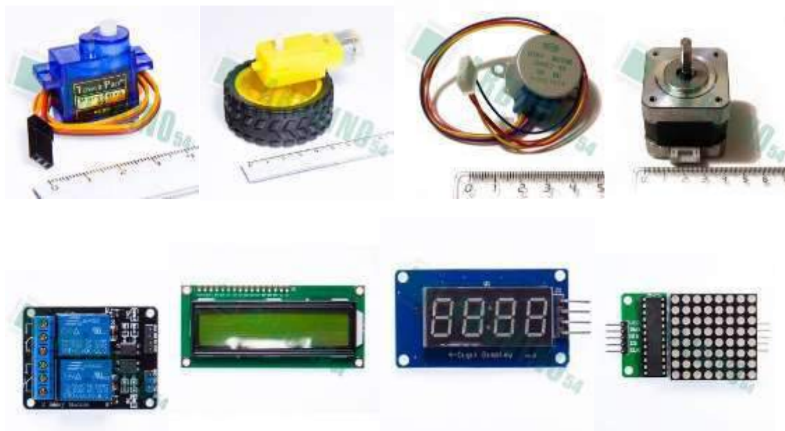
Рис. 2. Исполнительные механизмы и средства индикации для Arduino
