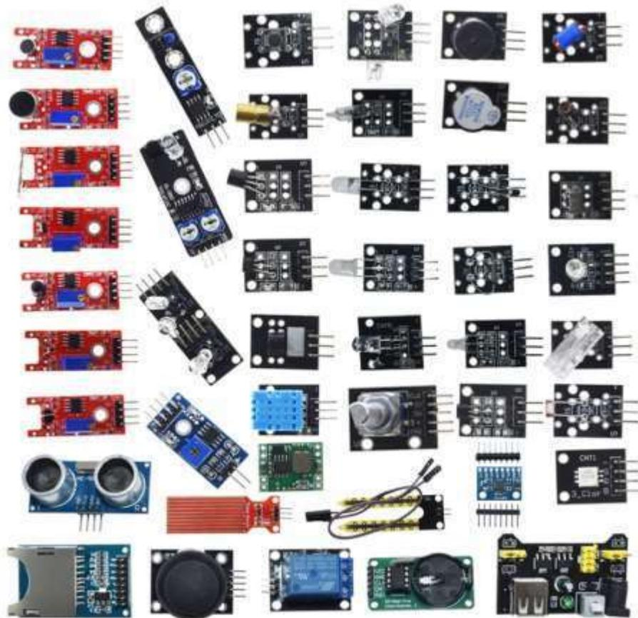
**Рис. 1. Сенсоры и модули для Arduino**
