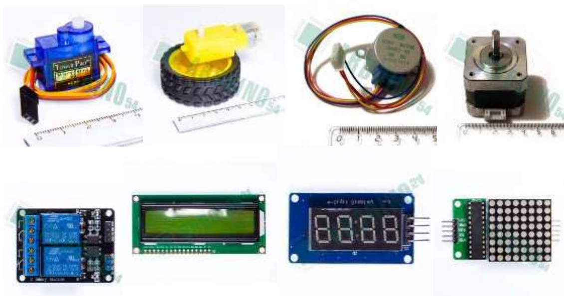
Рис. 2. Исполнительные механизмы для Ардуино
