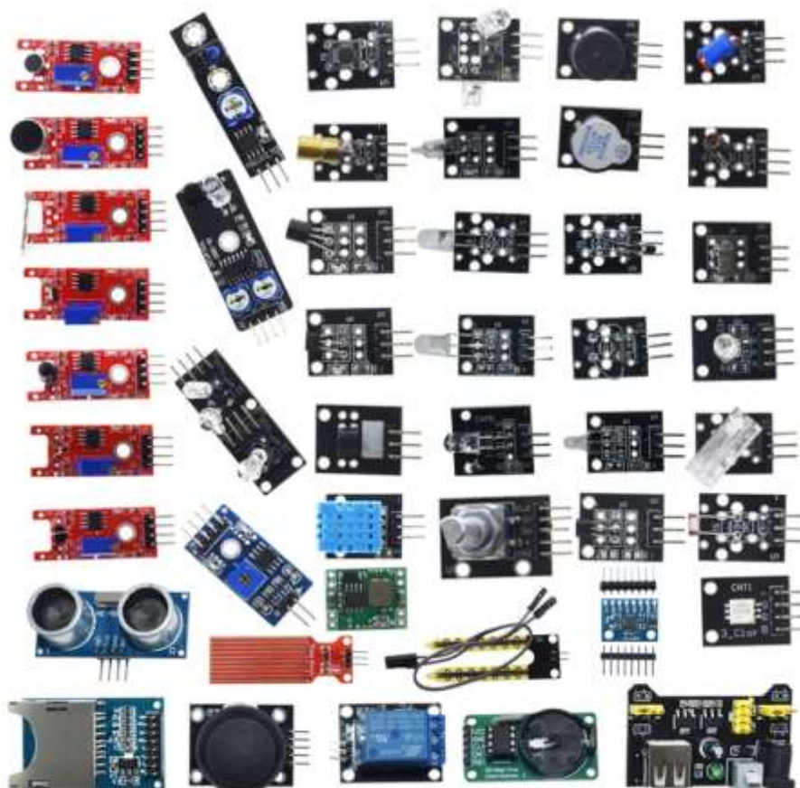
Рис. 1. Сенсоры и модули для Ардуино
