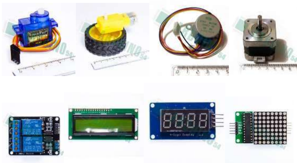
Рис. 2. Исполнительные механизмы и средства индикации для Arduino
