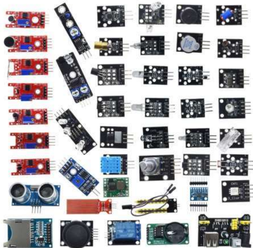
Рис. 1. Сенсоры и модули для Arduino
